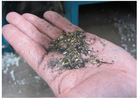
洗い加工 ⇒ 希硫酸に通す ⇒ 高温でブロー(焼く事により)VMが炭化 ⇒ クラッシング(からまっているVMを潰し取る) ⇒ 乾燥
